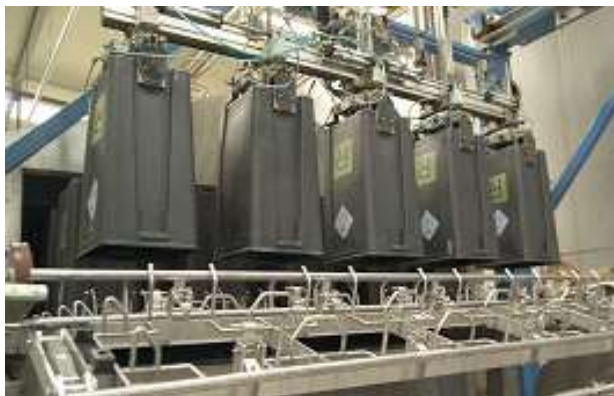
Figura 4: Posizionamento dei contenitori nei cestelli della lavacontenitori
