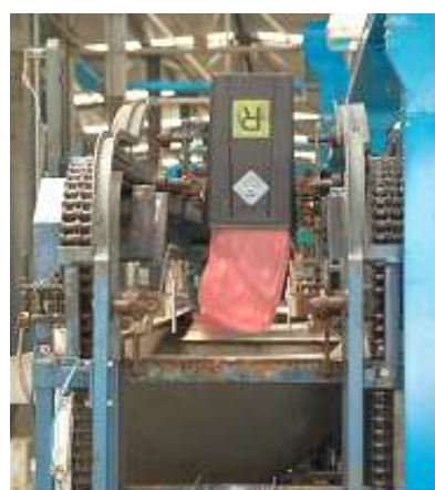
Figura 3: Svuotamento del contenitore
