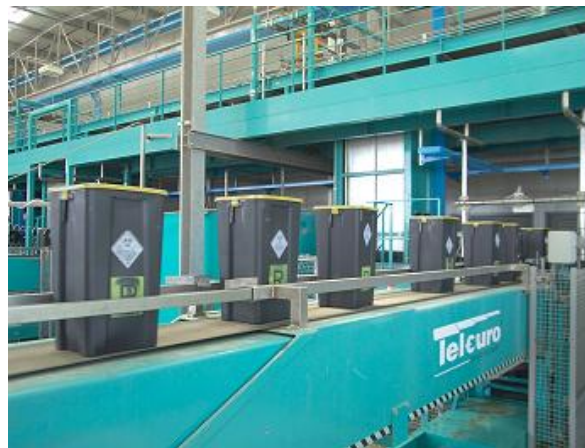
Figura 7: Sistema di trasporto automatizzato dei contenitori
