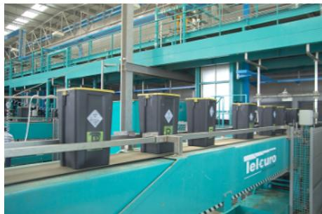
Lo scarico viene effettuato con modalità operative e in specifiche zone differenziate in funzione del tipo di contenitore. L'impianto è predisposto in modo da limitare al massimo la movimentazione dei contenitori da parte del personale, il contatto degli operatori con i rifiuti e ogni possibile rischio di contaminazione ambientale.
