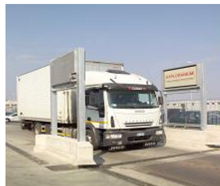
Figura 5: Portale per la rilevazione della radioattività
