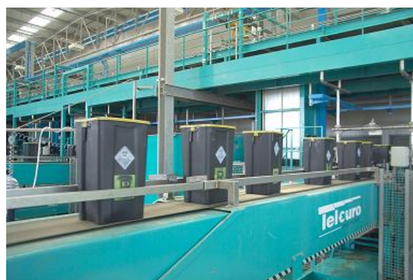
Figura 6: Sistema di trasporto automatizzato dei contenitori
