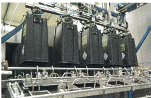
Figura 4: Posizionamento dei contenitori nei cestelli della lavacontenitori
