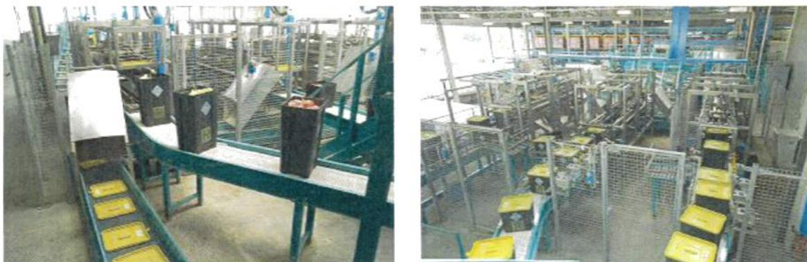
Figura 8: Sistema di movimentazione automatizzata dei contenitori
