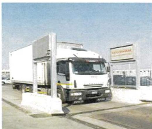
Figura 7: Portale per la rilevazione della radioattività
