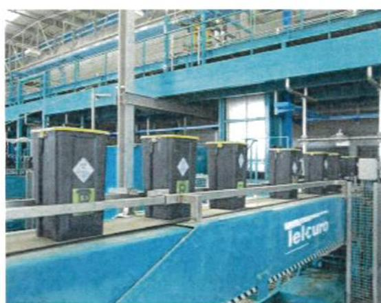
Figura 6: Sistema di trasporto automatizzato dei contenitori
